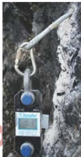
Slika 14: Upogib pri 3 kN in 6 kN
