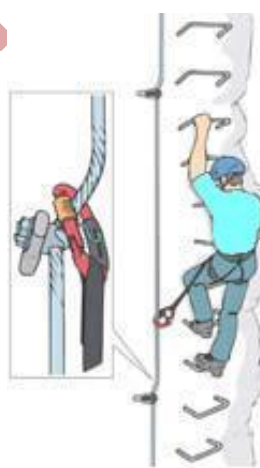
Slika 9: Vponka na stisnjenih sidrih z nenapeto jekleno vrvjo
