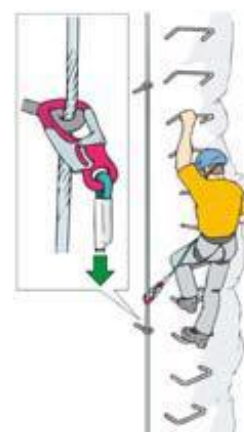
Slika 10: Vponka na očesnih sidrih z močno s prednapeto jekleno vrvjo
