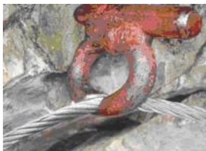
Slika 19: odbrušena očesa sider
